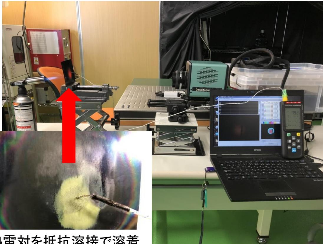
熱電対を抵抗溶接で溶着
